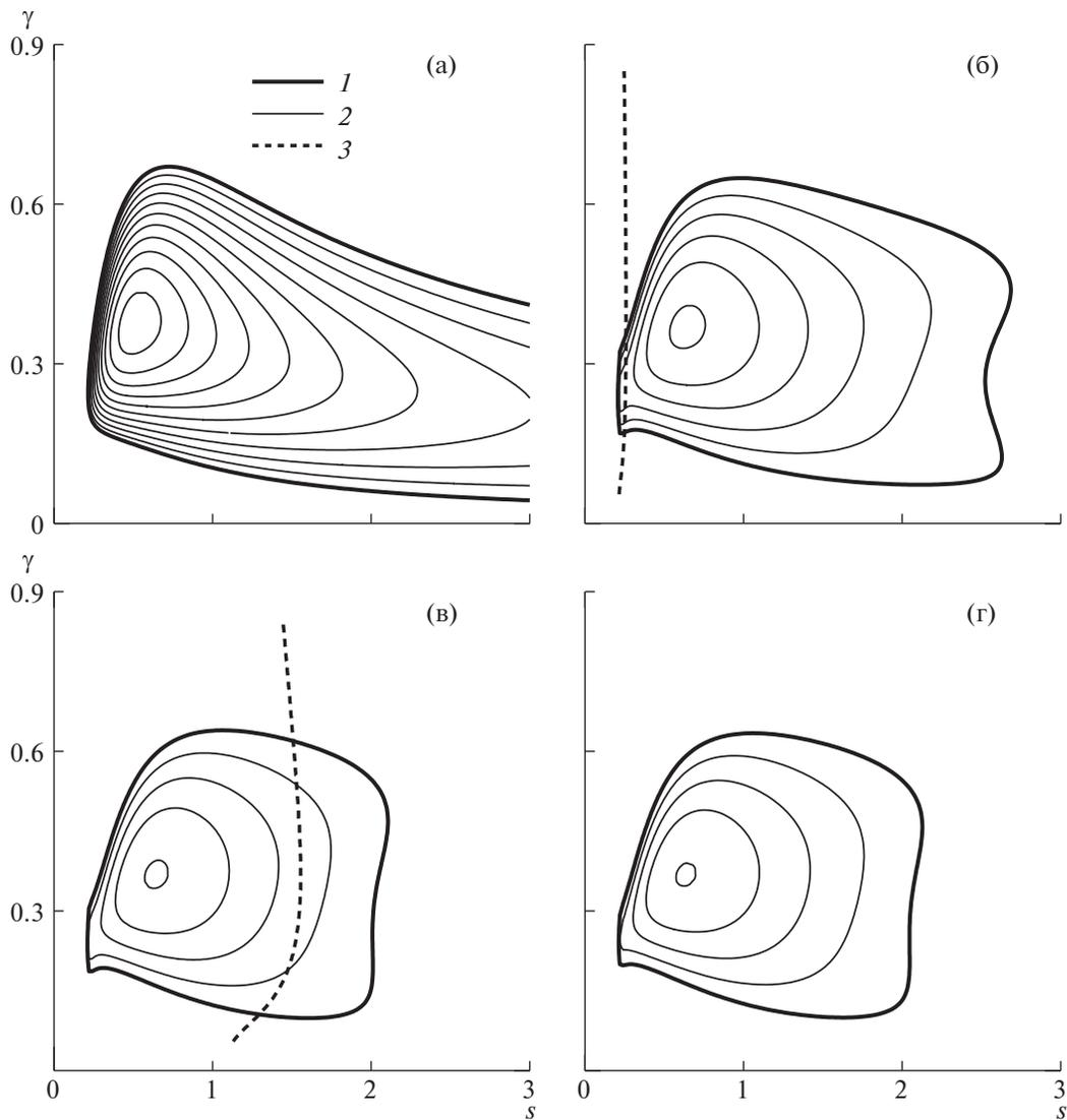
**Рис. 5.** Характеристики устойчивости течения: (а) – в отсутствие управления, (б, в, г) – при управлении с углами наклона актуаторов  $\varphi = 30^\circ, 60^\circ, 75^\circ$ ; 1 – кривые нейтральной устойчивости, 2 – линии уровня инкрементов нарастания с интервалом 0.001, 3 – кривые резонансного возбуждения модуляции течения.
