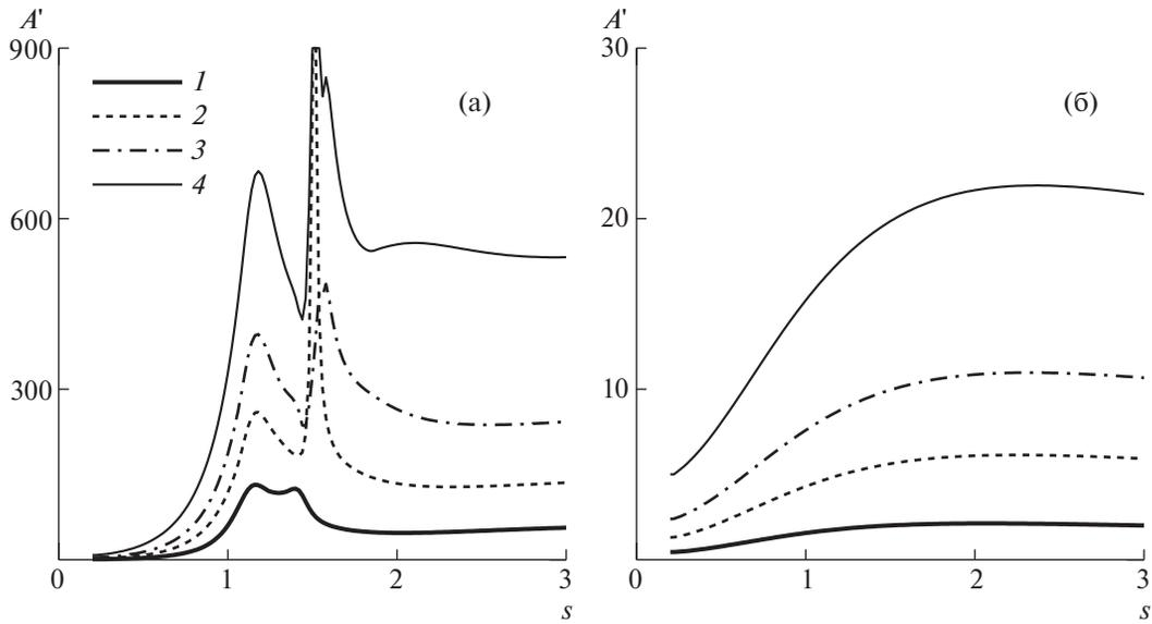
Рис. 6. Распределение интенсивности возмущений, вызванных местной модуляцией управляющего воздействия при угле наклона актуаторов  $\varphi = 60^\circ, 75^\circ$  (а, б) для расстояний между актуаторами  $\Pi = 6, 9, 12, 18$  (1–4).
