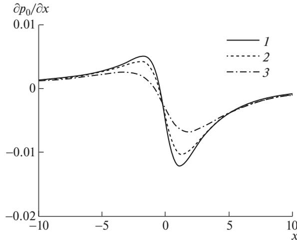
Рис. 8. Распределение продольного градиента давления, индуцируемого начальным участком системы управления, при  $y = 0, 1, 2$  (1–3).
