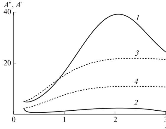
**Рис. 7.** Распределения амплитуд возмущений, генерируемых начальным участком системы управления (1, 2) в сравнении амплитудами возмущений, порождаемых локальной модуляцией управляющего воздействия (3, 4) при угле наклона актуаторов  $\varphi = 75^\circ$ ; (1, 3) –  $\Pi = 18$ , (2, 4) –  $\Pi = 12$ .
