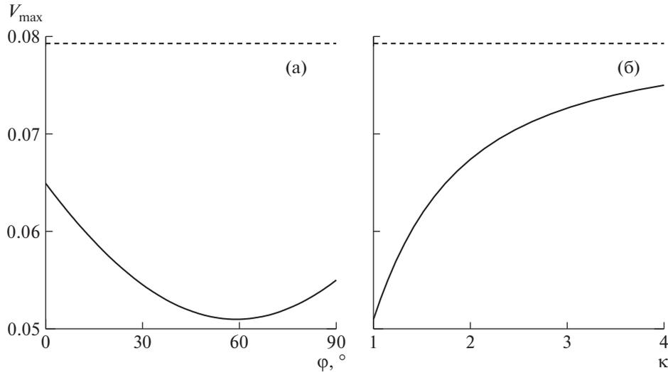
Рис. 4. Зависимость абсолютного максимума скорости поперечного течения от угла наклона актуаторов (а) и от коэффициента увеличения скорости (б).
