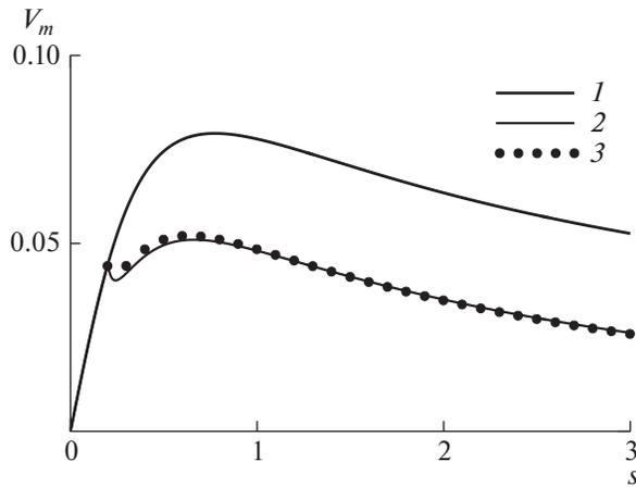
**Рис. 2.** Распределение местной интенсивности поперечного течения в отсутствие управляющего воздействия (1), при силовом воздействии для углов наклона актуаторов  $\varphi = 60^\circ, 75^\circ$  (2, 3).
