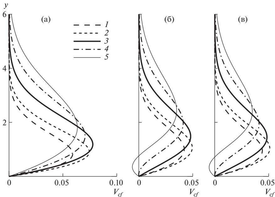
**Рис. 3.** Профили скорости поперечного течения при отсутствии управления (а) и при силовом воздействии с углами наклона актуаторов  $\varphi = 60^\circ, 75^\circ$  (б, в) в сечениях  $s = 0.3, 0.5, 1, 1.5, 2$  (1–5).
