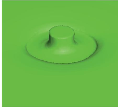
**Рис. 3.** Пример трехмерного расчета кругового гидравлического прыжка для этилен-гликоля с  $a = 5$  мм,  $Q = 31$  мл/с и  $h = 2$  мм.
