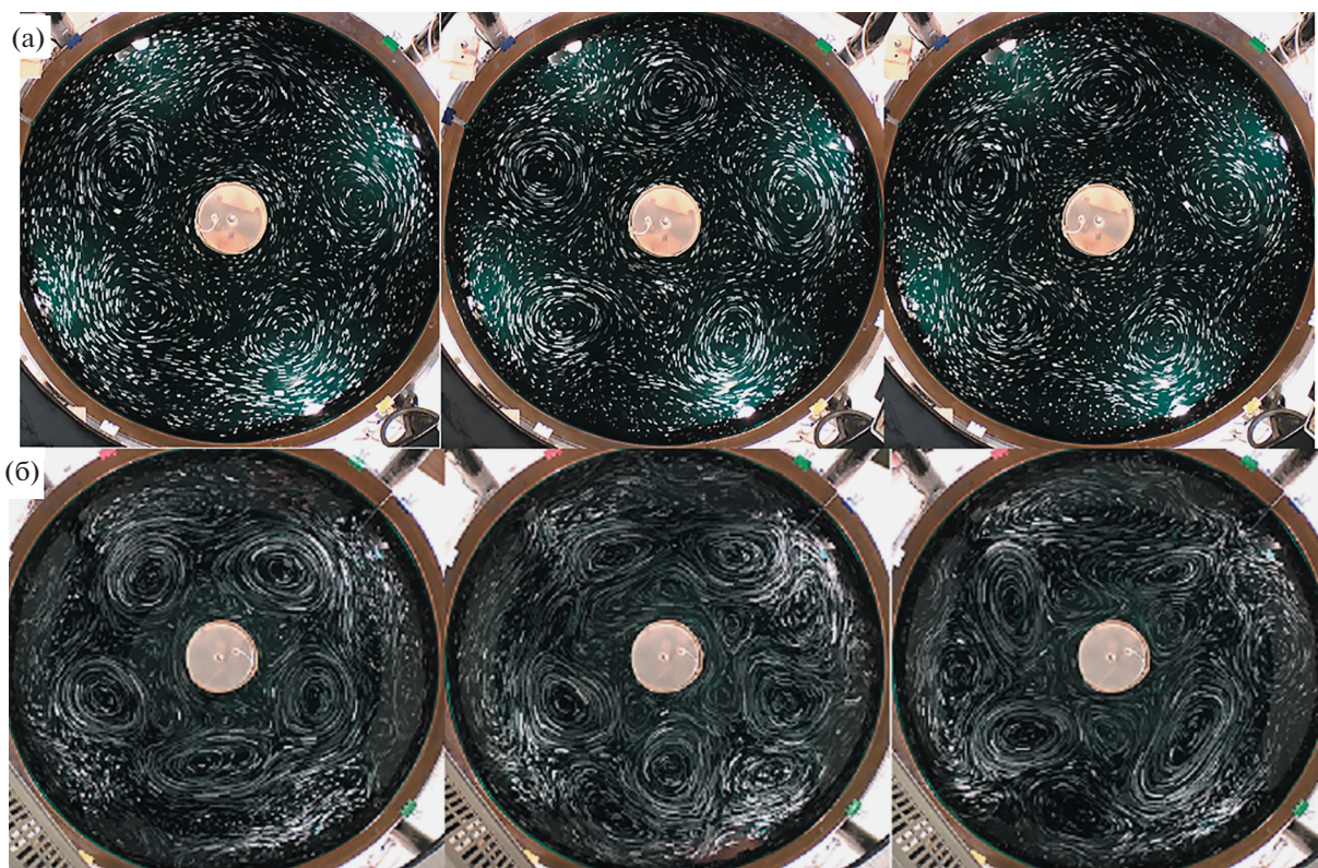
Рис. 6. Траектории частиц в канале 2, отнесенные к моментам времени t = 1, 3, 5 мин, при периодах внешнего вращения (а) T = 32.9 с, (б) T = 40.6 с.
