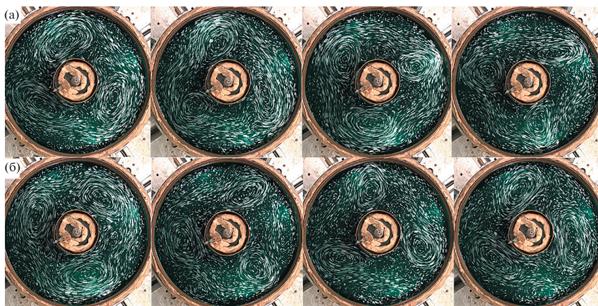
Рис. 3. Траектории частиц в канале I , отнесенные соответственно (слева направо) к моментам времени t = 0.5, 2, 5.5, 6.0 мин, при периодах внешнего вращения (а) T = 20.3 с, (б) T = 17.7 с.
