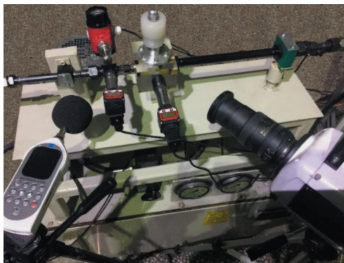
Рис. 5. Экспериментальная система для наблюдения люминесценции при гидравлической кавитации.
