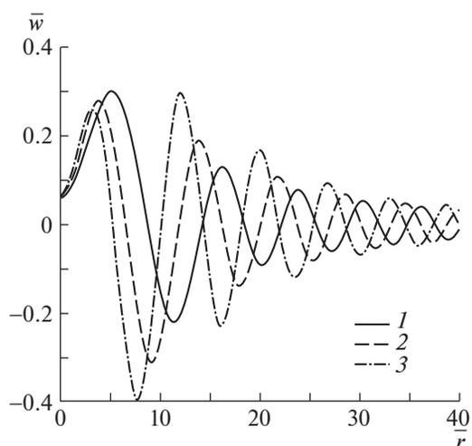
**Рис. 7.** Зависимость вертикальных прогибов пластины от расстояния до центра области давления при  $\bar{t} = 60$ ,  $q_1 = q_2 = 1.5$ ,  $q_3 = 0.5$ :  $1-3 - \theta = 0, 15, 45^\circ$ .
