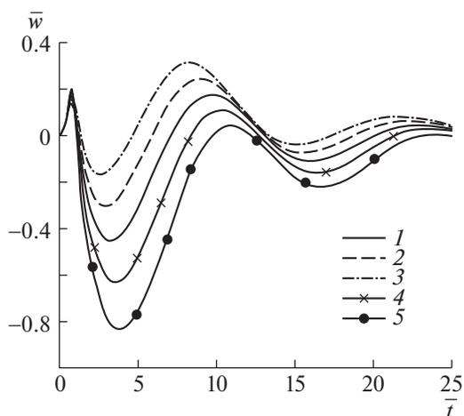
**Рис. 6.** Зависимость от времени вертикальных прогибов пластины в различных точках окружности  $r = 2L$  при  $b = 0.5 \text{ с}^{-1}$  и  $q_1 = q_2 = 1.5$ ,  $q_3 = 0.5$ :  $1-5 - \theta = 0, 15, 45, 105, 135^\circ$ .
