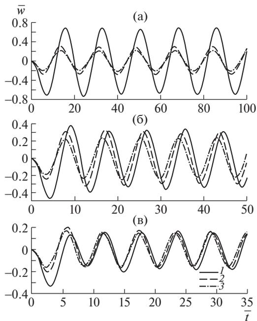
**Рис. 3.** Прогибы упругой пластины в зависимости от времени при  $r = 0$ : (а–в) –  $\omega = 0.25, 0.5, 0.75 \text{ с}^{-1}$ ; 1 –  $q_1 = q_2 = 1.5, q_3 = 0.5$ ; 2 –  $q_1 = 1, q_2 = 0, q_3 = 0.5$ ; 3 –  $q_1 = q_2 = q_3 = 0$ .
