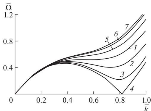
**Рис. 1.** Дисперсионные зависимости  $\bar{\Omega}(\bar{k}, \theta)$  при различных значениях  $\theta = \pi n/12$ : 1 –  $n = 0, 6, 12$ ; 2 –  $n = 1, 5$ ; 3 –  $n = 2, 4$ ; 4 –  $n = 3$ ; 5 –  $n = 7, 11$ ; 6 –  $n = 8, 10$ ; 7 –  $n = 9$ .
