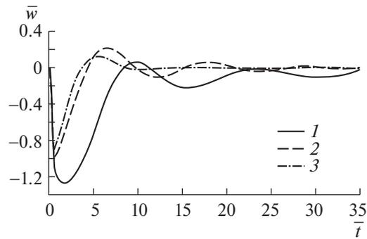
**Рис. 5.** Зависимость от времени вертикальных прогибов пластины в центре пятна давления  $r = 0$  для  $b = 0.5 \text{ с}^{-1}$  при различных параметрах сжатия: 1 –  $q_1 = q_2 = 1.5, q_3 = 0.5$ ; 2 –  $q_1 = 1, q_2 = 0, q_3 = 0.5$ ; 3 –  $q_1 = q_2 = q_3 = 0$ .
