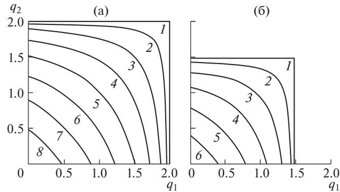
**Рис. 2.** Области значений  $q_1$  и  $q_2$ , которые при различных  $q_3 = 0.25(j-1)$  для  $j = 1, \dots, 8$  ограничивают зоны устойчивости упругой пластины (а) и нормальной дисперсии (б) при  $h = 2$  м для бесконечно глубокой жидкости. Номер кривой соответствует значению  $j$ .
