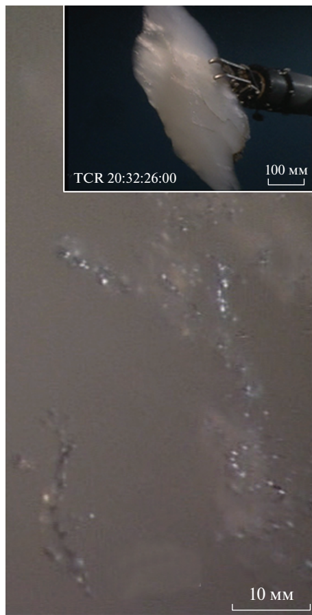
Рис. 3. Выход пузырей из трещин на поверхности монолитного гидрата метана, находящегося в водной среде за пределами ЗУГМ [10, 11]. Глубина 261 м, скорость подъема гидрата метана v_z = -0.149 м/с. На врезке представлен монолит гидрата метана, на поверхности которого наблюдаются выходы пузырей.
