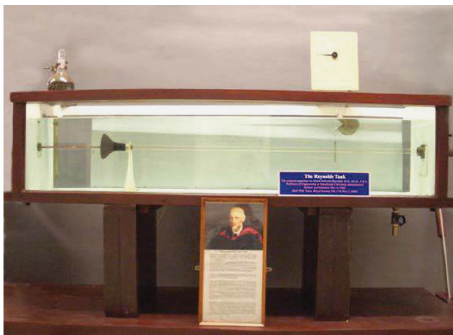
Рис. 3. Экспериментальная установка О. Рейнольдса. Хранится в университете г. Манчестера, Великобритания.
