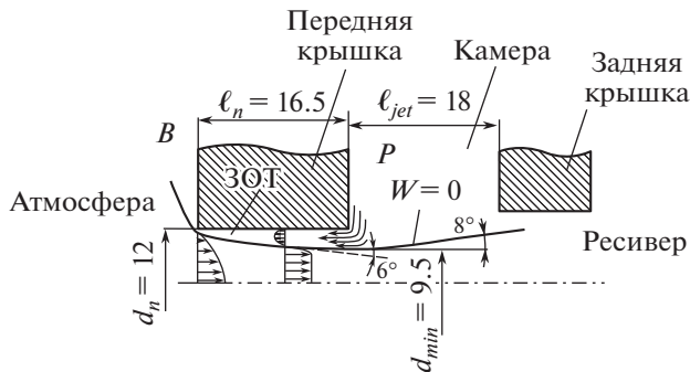
Рис. 4. Схема развития струи и формирования зоны обратных токов в канале сопла.
