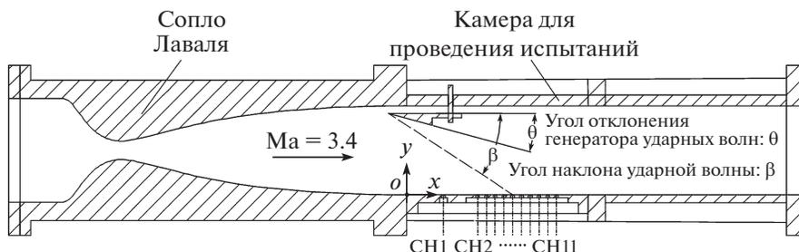
Рис. 1. Схема модельной установки.
