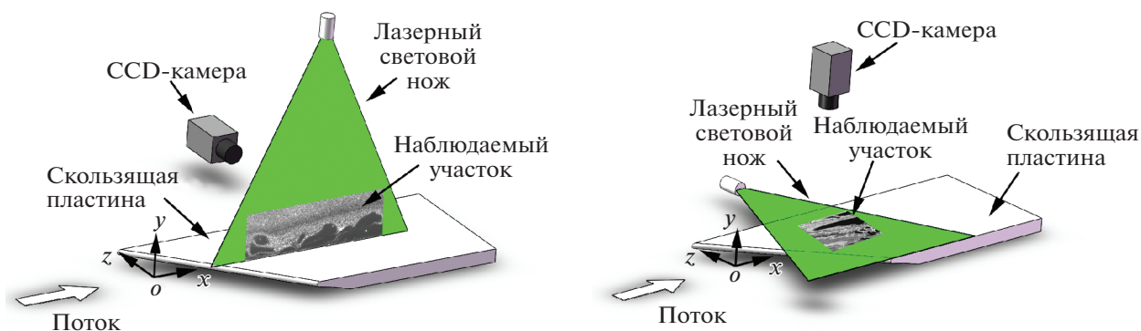
Рис. 7. Схема измерений на модели скользящей пластины: (а) схема измерений в продольной плоскости; (б) схема измерений в поперечной плоскости.
