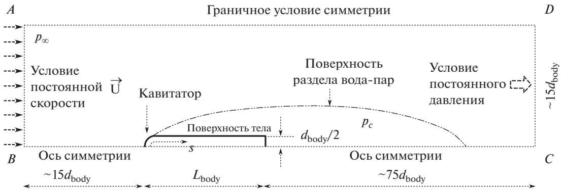
Рис. 2. Двумерная расчетная область для тела длиной 100 мм с полусферическим кавитатором (для тел иной длины расстояние от кормы тела до выходной границы меняется в соответствии с длиной тела; АВ (и DC), ВС и расстояния от кавитатора до входной границы остаются неизменными, т.е. 100, 700 и 100 мм соответственно)
