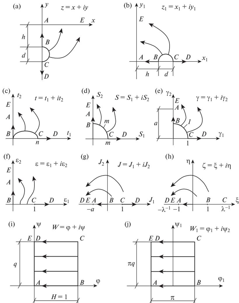
**Рис. 2.** Схема последовательных конформных отображений, устанавливающая аналитическую взаимосвязь областей физического течения  $z = x + iy$  и комплексного потенциала  $W = \varphi + i\psi$  (прямоугольника).
