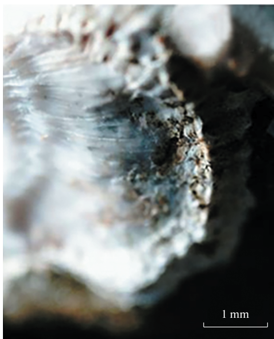
Рис. 9. Участок 3 (на рис. 6). След выламывания раковины (движение фронта трещины слева направо).
