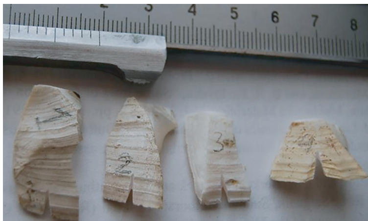
Рис. 3. Образцы – фрагменты корпуса раковин для определения K_{IC} .
