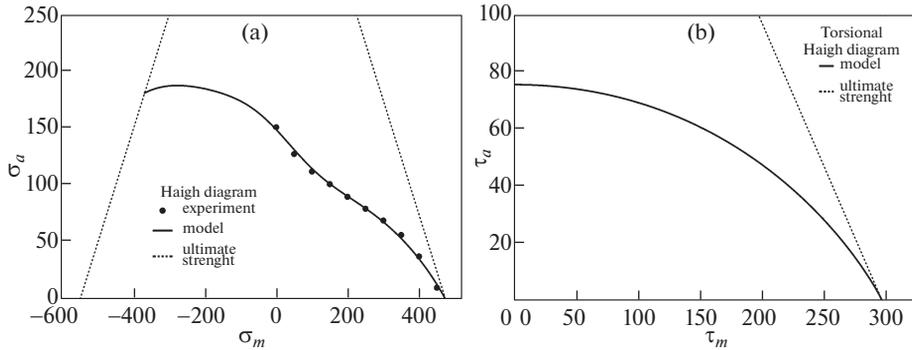
Рис. 2. Диаграммы Хейга для алюминиевого сплава AA2024-T4: для одноосного нагружения (а), для сдвигового нагружения (б). По осям отложены МПа.
