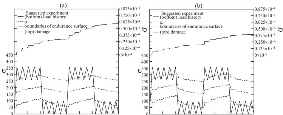
Рис. 7. Предлагаемый эксперимент, расчет динамики накопления поврежденности с помощью модели (2.1): набор констант (3.9) (а) и набор констант (4.1) (б). Напряжения указаны в МПа.
