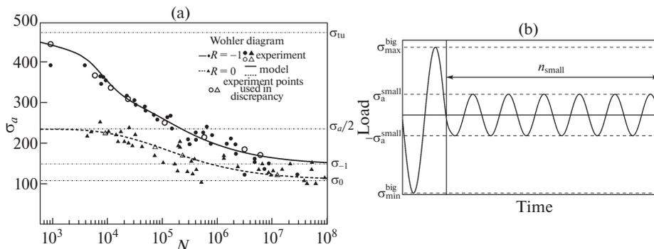
**Рис. 4.** Диаграмма Велера для AA2024-T4: результаты экспериментов и предсказание модели для симметричных ( $R = -1$ ) и отнулевых ( $R = 0$ ) циклов (а) и один “такт” нерегулярного нагружения [9] (б). По вертикальной оси отложены МПа.
