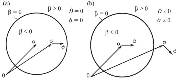
Рис. 1. Поверхность выносливости в пространстве напряжений.
