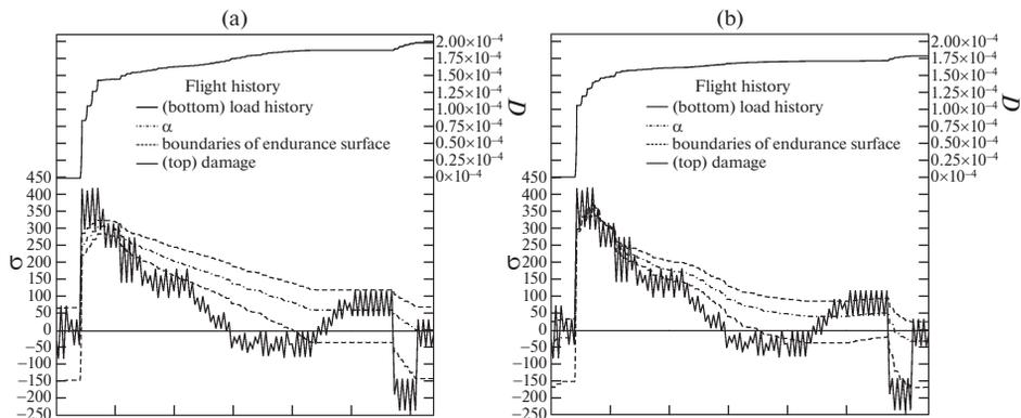
Рис. 6. Расчет динамики накопления поврежденности на полетном цикле с помощью модели (2.1): набор констант (3.9) (а) и набор констант (4.1) (б). Напряжения указаны в МПа.
