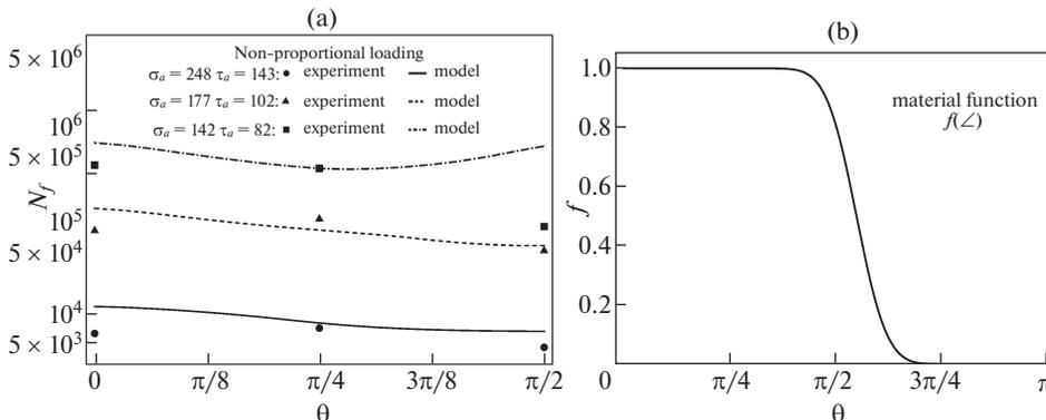
**Рис. 5.** Сравнение результатов экспериментов на непропорциональное нагружение алюминиевого сплава AA2024-T4 [8] с предсказаниями модели (а), материальная функция  $f(\angle)$  при  $L_5 = 1.1$ , отвечающая за зависимость скорости движения поверхности выносливости от направления изменения напряженного состояния (б).
