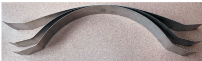
Рис. 5. Образцы заготовок после формообразования на прессе Т-600 по разным схемам обтяжки.
