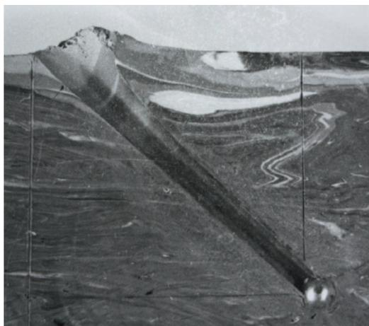
**Рис. 3.** Вид траектории движения шара при входе в пластилин вдали от свободной поверхности.
