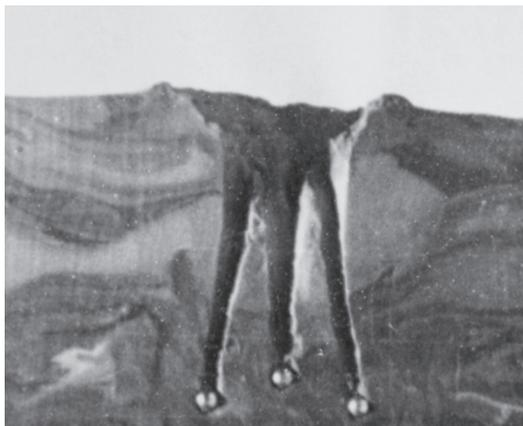
**Рис. 11.** Каверна в пластилине при ударе семью шарами, плотно лежащими в одной плоскости (один в центре, шесть вокруг).
