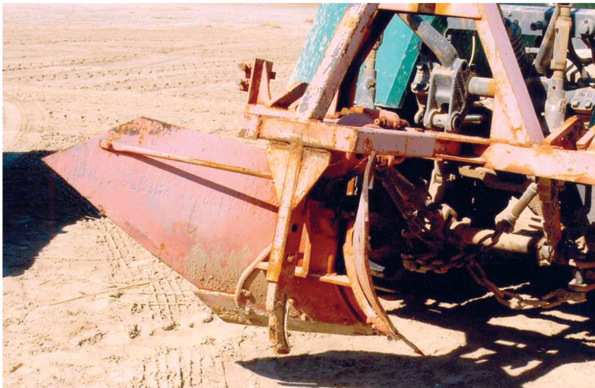
Рис. 2. Орудие для нарезки песконакопительных борозд со щелевателем.
