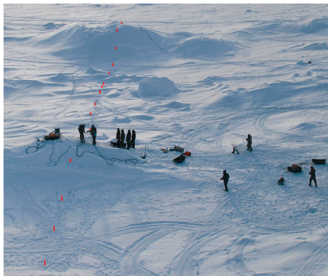
Рис. 1. Исследование старого тороса на северо-западе Восточно-Сибирского моря (красными маркерами отмечены видимые точки бурения на профиле)
