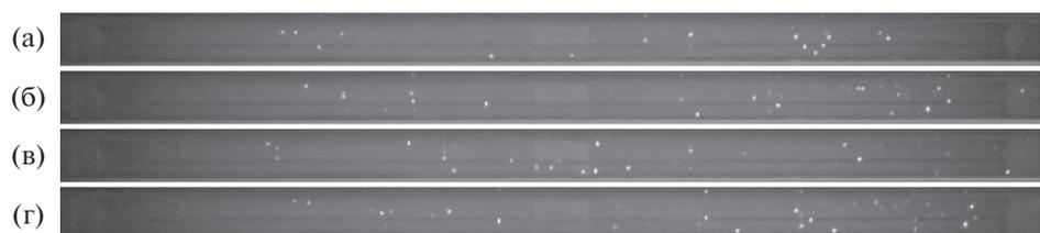
**Рис. 9.** Кадры видеogramмы зажигания и горения частиц смеси У 80% + Б 20% размерами 100–200 мкм в условиях движения в потоке разогретого воздуха при  $T_a = 700^\circ\text{C}$  ( $\Delta t = 0.01$  с):  $t_d = 0.063$  с (а);  $t = t_d + \Delta t$  (б);  $t = t_d + 2\Delta t$  (в);  $t = t_d + 3\Delta t$  (г).
