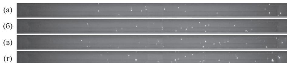
**Рис. 8.** Кадры видеogramмы зажигания и горения частиц смеси У 90% + Б 10% размерами 100–200 мкм в условиях движения в потоке разогретого воздуха при  $T_a = 700^\circ\text{C}$  ( $\Delta t = 0.01$  с):  $t_d = 0.079$  с (а);  $t = t_d + \Delta t$  (б);  $t = t_d + 2\Delta t$  (в);  $t = t_d + 3\Delta t$  (г).
