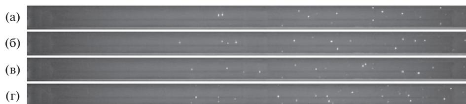
**Рис. 6.** Кадры видеороликов зажигания и горения частиц черногорского каменного угля размерами 100–200 мкм в условиях движения в потоке разогретого воздуха при  $T_a = 700^\circ\text{C}$  ( $\Delta t = 0.01$  с):  $t_d = 0.095$  с (а);  $t = t_d + \Delta t$  (б);  $t = t_d + 2\Delta t$  (в);  $t = t_d + 3\Delta t$  (г).
