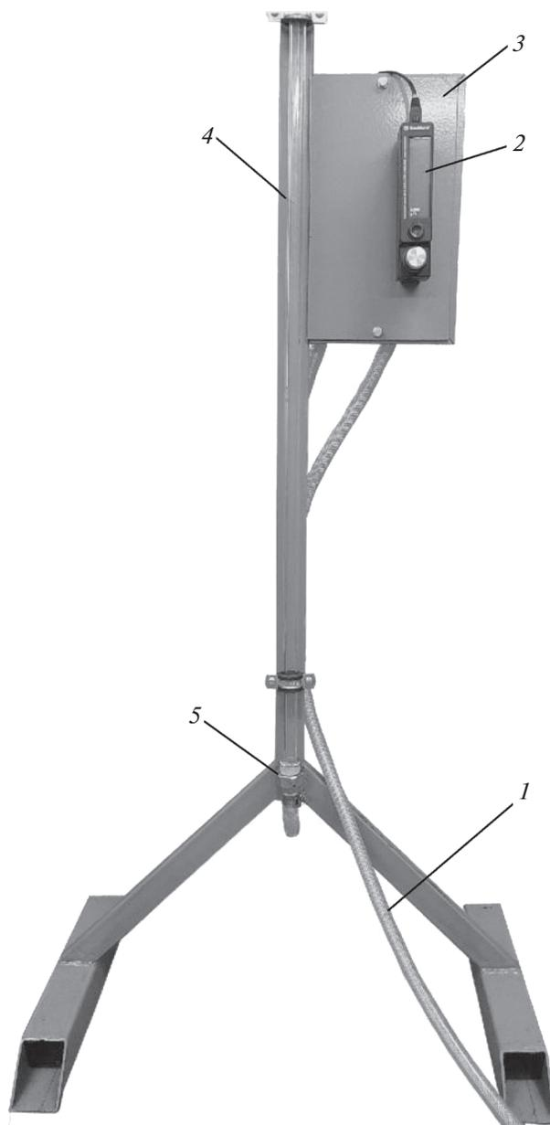
**Рис. 1.** Экспериментальный стенд: 1 – трубопровод (подключенный к компрессору), 2 – массовый расходомер *BronkhorstMV-306*, 3 – стойка, 4 – стеклянная трубка, 5 – соединительная муфта (с брезентовой прокладкой внутри).
