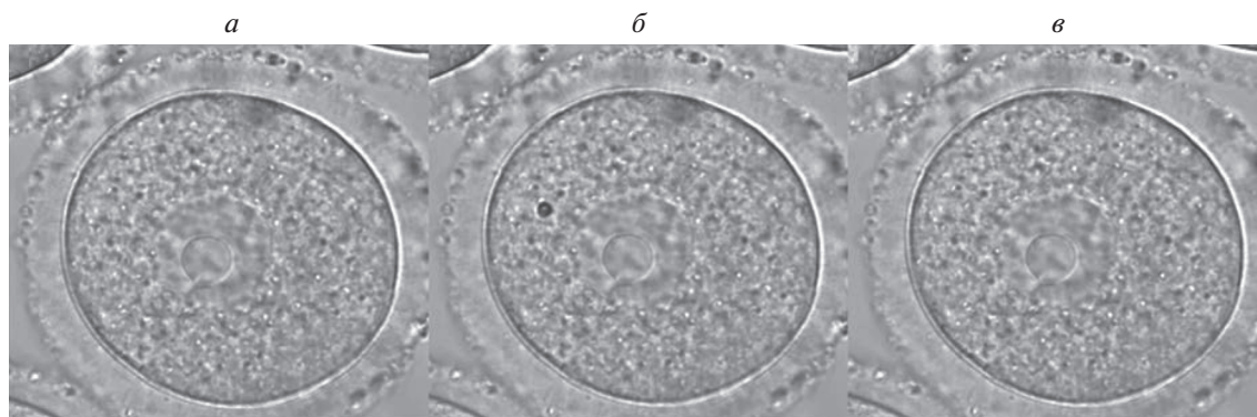
Рис. 7. Серия кадров из видеоизображения ооцита при пробое. Энергия импульса – 28.2 нДж; а – до выстрела, б – спустя 50 мс после выстрела, в – спустя 500 мс после выстрела. Время жизни пузыря согласно видеоизображению составляло 200–250 мс. Максимальный диаметр – \approx 3.9 мкм. Время жизни соответствующего кавитационного пузыря, измеренное по сигналу светорассеяния, составляло 1.47 мкс.
