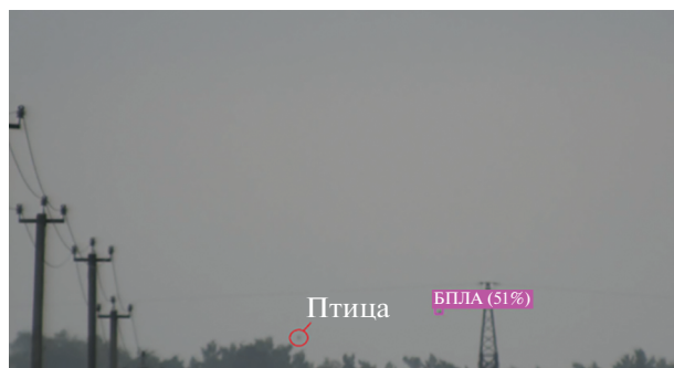
Рис. 8. Распознавание беспилотного объекта на расстоянии в 1000 м с фокальным расстоянием объектива 114.5 мм.
