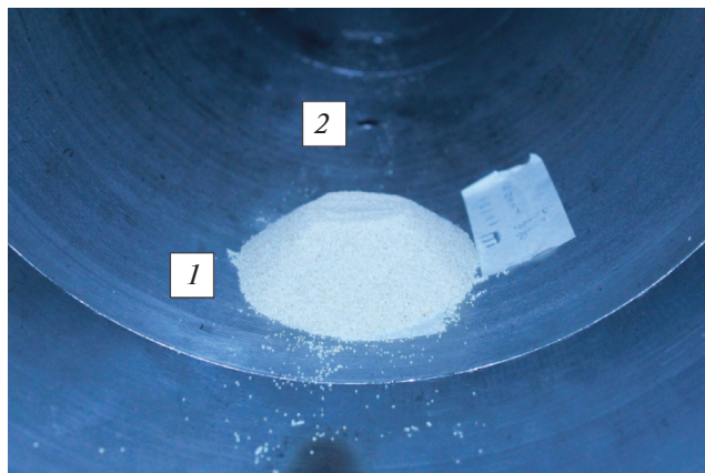
Рис. 1. Вид внутренней поверхности КУТ: 1 — слой песка толщиной h = 20 мм, дисперсность — 0.5–0.8 мм; 2 — датчик давления перед насыпным слоем.
