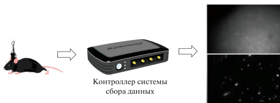
Рис. 2. Схематическое изображение работы минископа, полученный сигнал с чувствительного сенсора камеры поступает в контроллер системы сбора данных, далее полученное изображение выводится на экран монитора.
