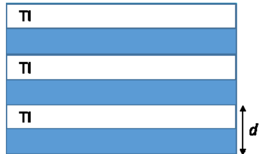
Рис. 1. Схематическое изображение многослойной структуры. Незакрашенные участки обозначают слои топологических изоляторов (ТИ), а закрашенные — обычные зонные изоляторы
