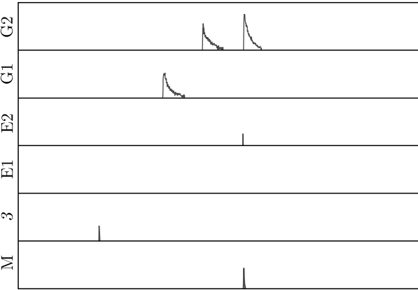
Рис. 6. Осциллограмма экспериментального события с выходом двух последовательных \gamma -квантов. Масштаб рисунка по времени — 20 мкс
