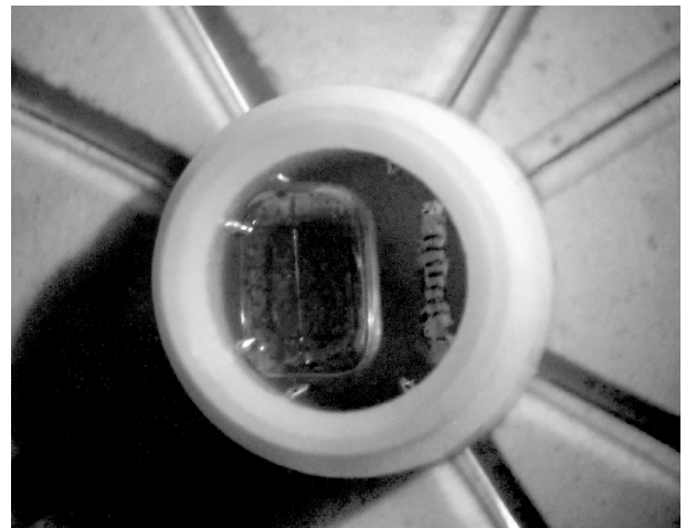
Рис. 3. Образец (калибровочный) для эксперимента и манганиновый манометр в ампуле с гидростатической средой
