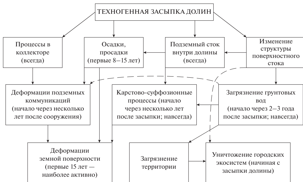
Рис. 3. Организация процессов—последствий техногенного уничтожения гидросети городов на платформенных территориях (на примере Москвы).
