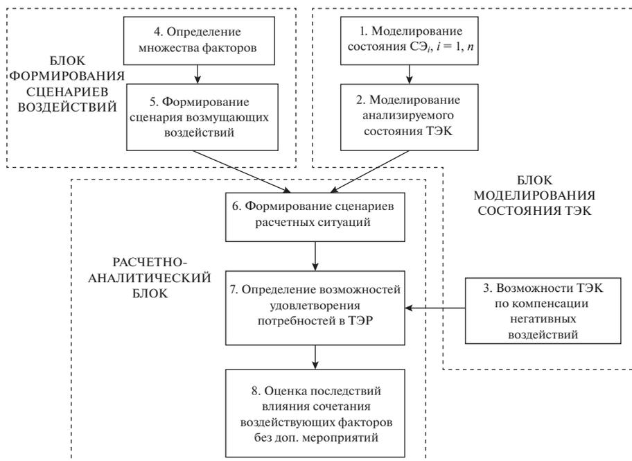
**Рис. 1.** Алгоритм оценки влияния факторов, воздействующих на надежность топливо- и энергоснабжения потребителей.
