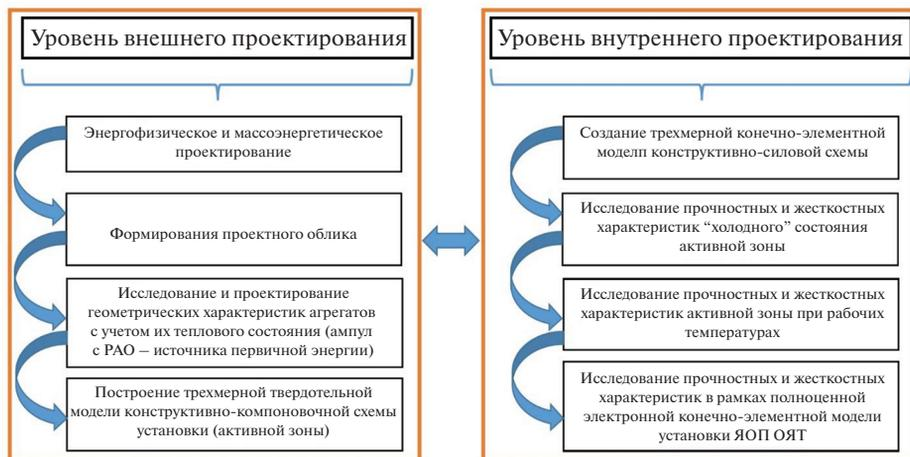
Рис. 2. Система многоуровневого проектирования установки по утилизации РАО с ЯОП энергии РАО.
