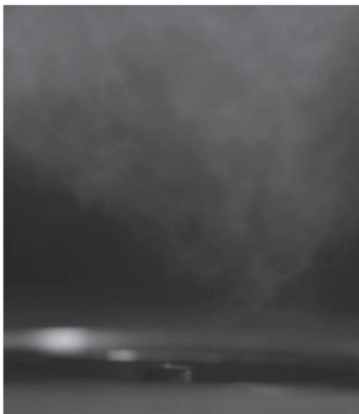
Рис. 2. Фотография турбулентного пламени частично перемешанной метано-воздушной смеси при числе Рейнольдса 15000.
