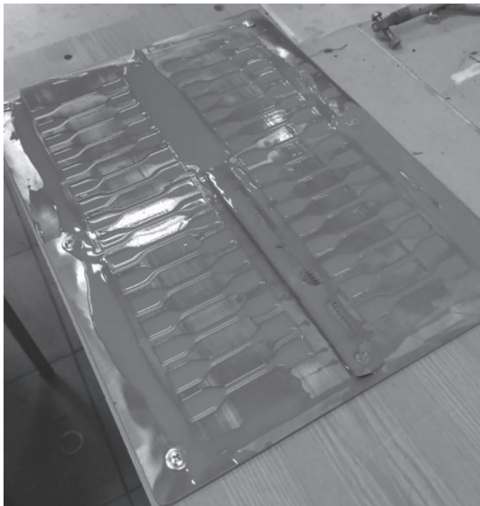
Рис. 4. Формовка испытательных образцов из кремнийорганического каучука в металлическую форму.
