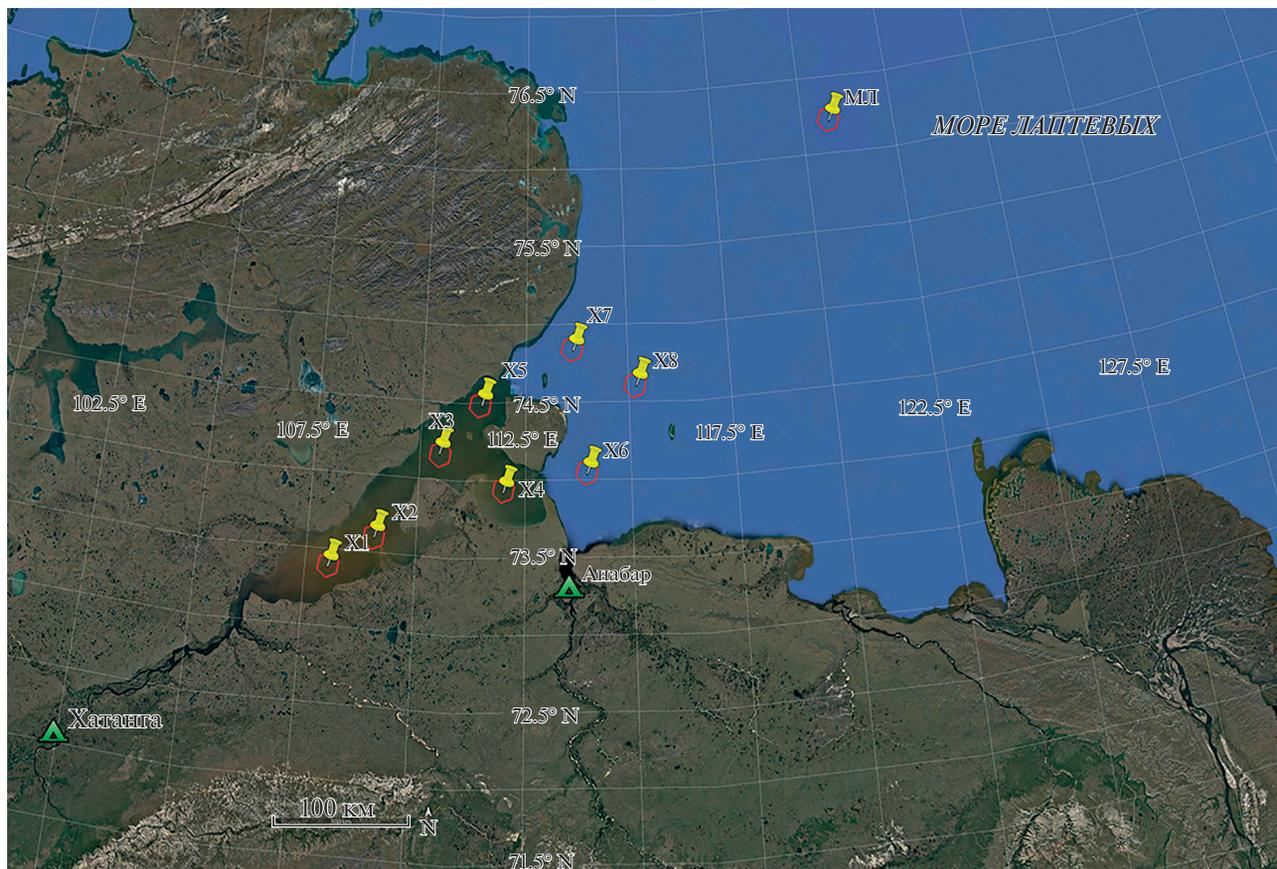
**Рис. 2.** Хатангский залив (море Лаптевых). Красные многоугольники – ячейки продукта L1C SMOS. Желтые значки – номера выбранных участков. Зеленые треугольники – метеорологические станции.
