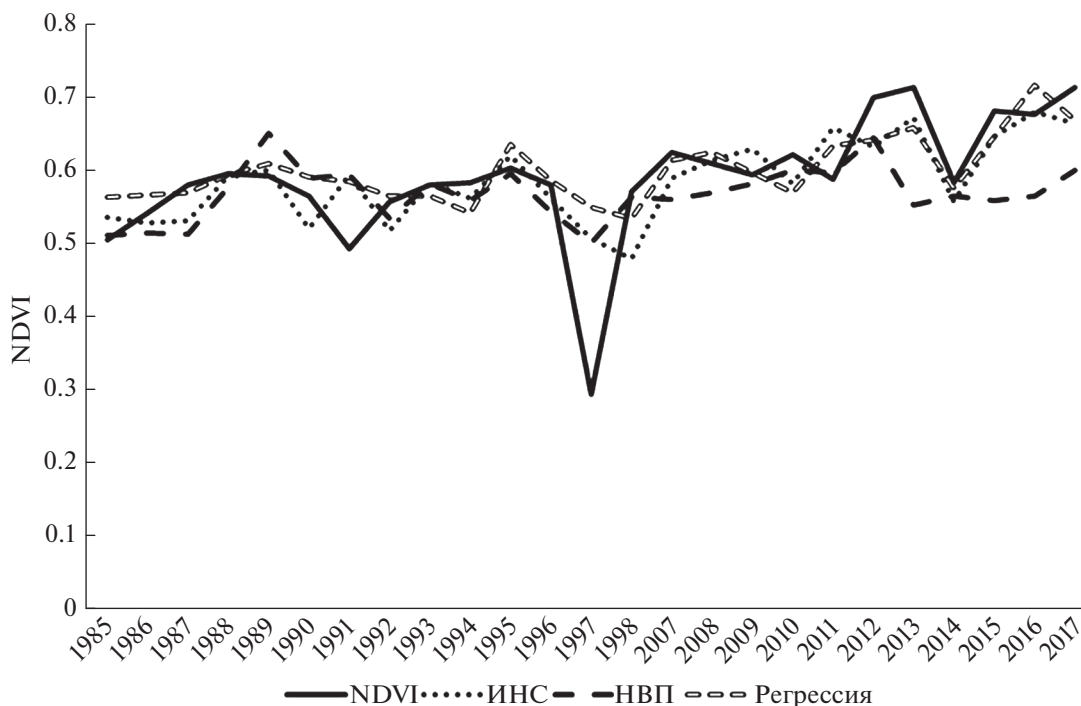
Рис. 5. Графики фактических и рассчитанных по моделям значений межгодовой динамики NDVI. Кривая NDVI – фактические значения индекса; кривая ИНС – модель, построенная по технологии искусственных нейронных сетей; кривая НВП – модель, построенная на основе нечеткостно-возможностного подхода; кривая Регрессия – линейная регрессионная модель.
