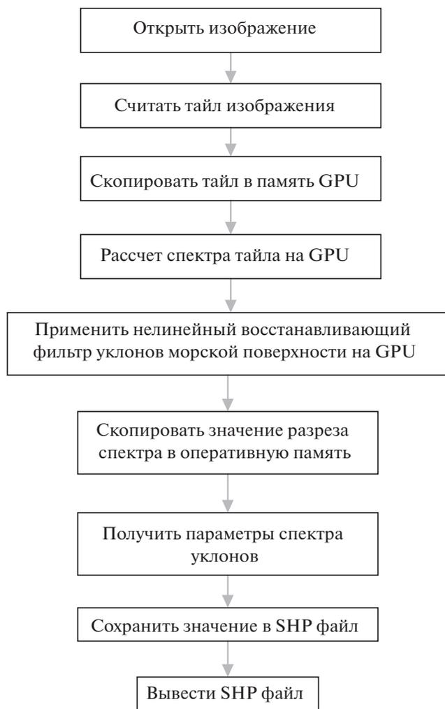
Рис. 1. Блок-схема алгоритма параллельной обработки космических изображений морской поверхности и регистрации пространственных спектров волнения.
