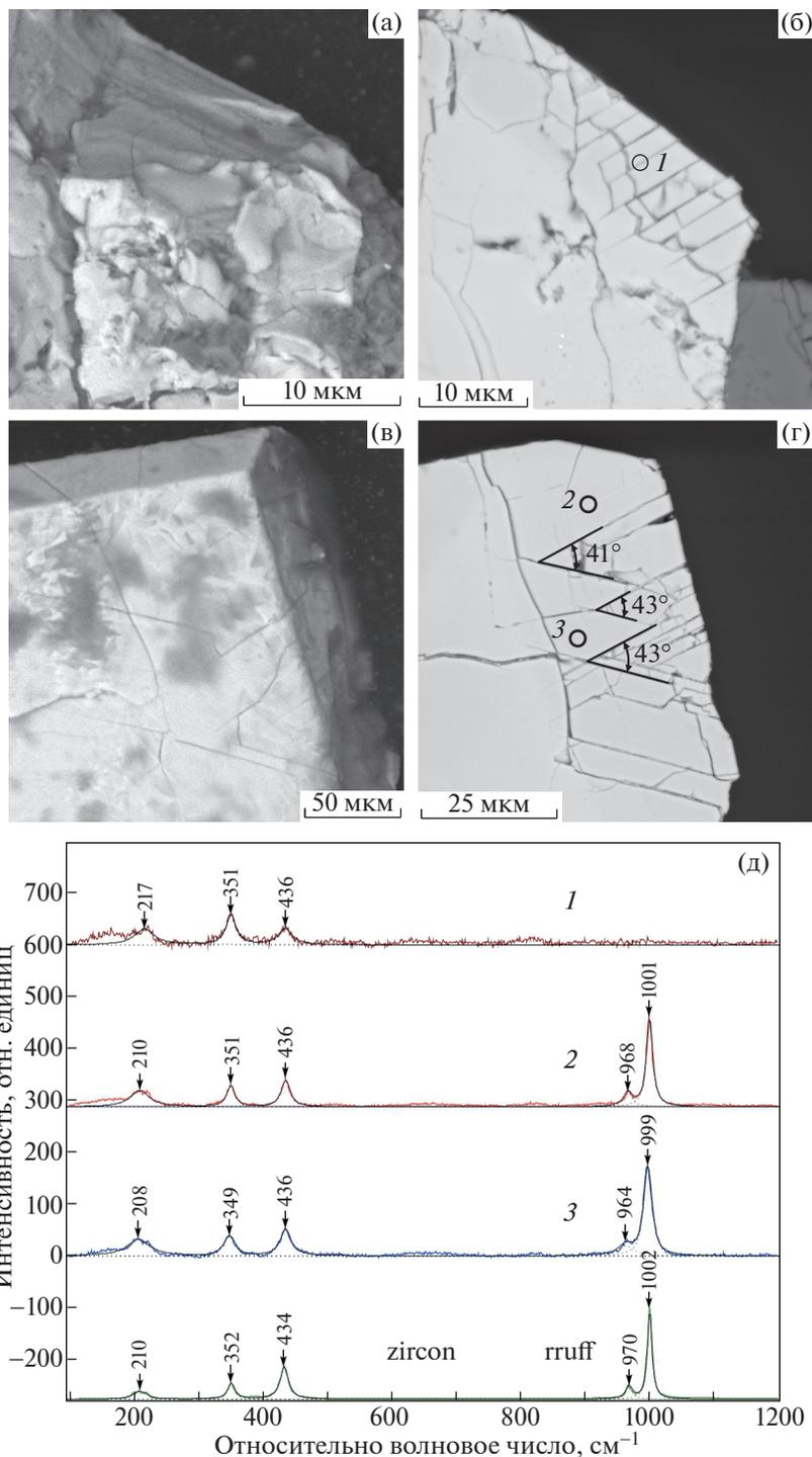
**Рис. 5.** Планарные элементы в цирконах из пробы 24P-04-2: а, в – естественная поверхность, б, г – полировка, д – КР-спектры. Изображения а–г получены в режиме BSE. Пиками с номерами обозначены точки анализов, отраженных на рис. д.
