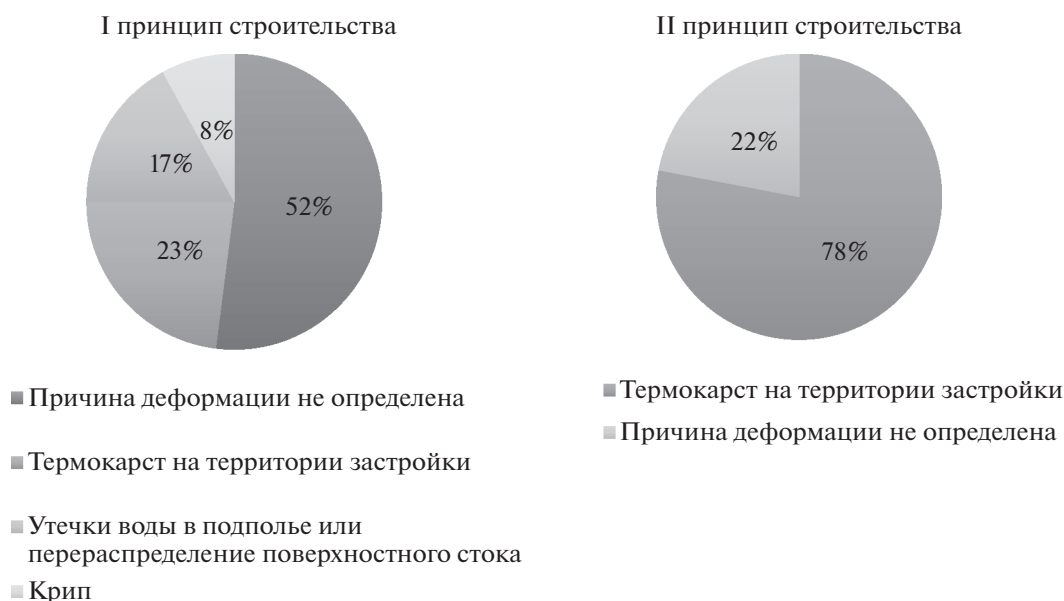
Рис. 8. Сопоставление статистик наблюдаемых недопустимых деформаций с визуальными признаками нарушения условий теплообмена через поверхность в зависимости от принципа строительства.
