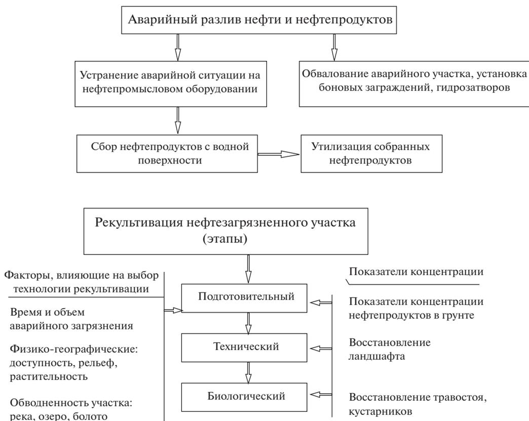
Рис. 6. Блок-схема проводимых природоохранных мероприятий при аварийном разливе нефтепродуктов<sup>3</sup>.
