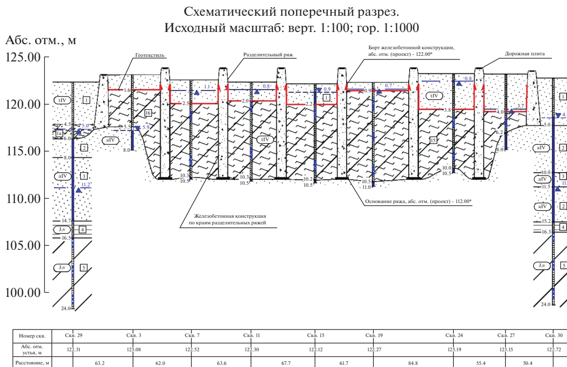
Рис. 2. Поперечный инженерно-геологический разрез полигона депонирования осадков по линии VIII–VIII (см. рис. 1).
