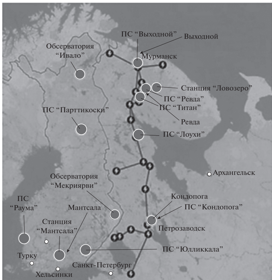
Рис. 1. Схема расположения измерительных устройств в проекте EURISGIC: кружками отмечены расположенные рядом обсерватории, измеряющие геомагнитное поле, и подстанции регистрации ГИТ. Стрелками и надписями указаны подстанции, данные которых используются в работе.
