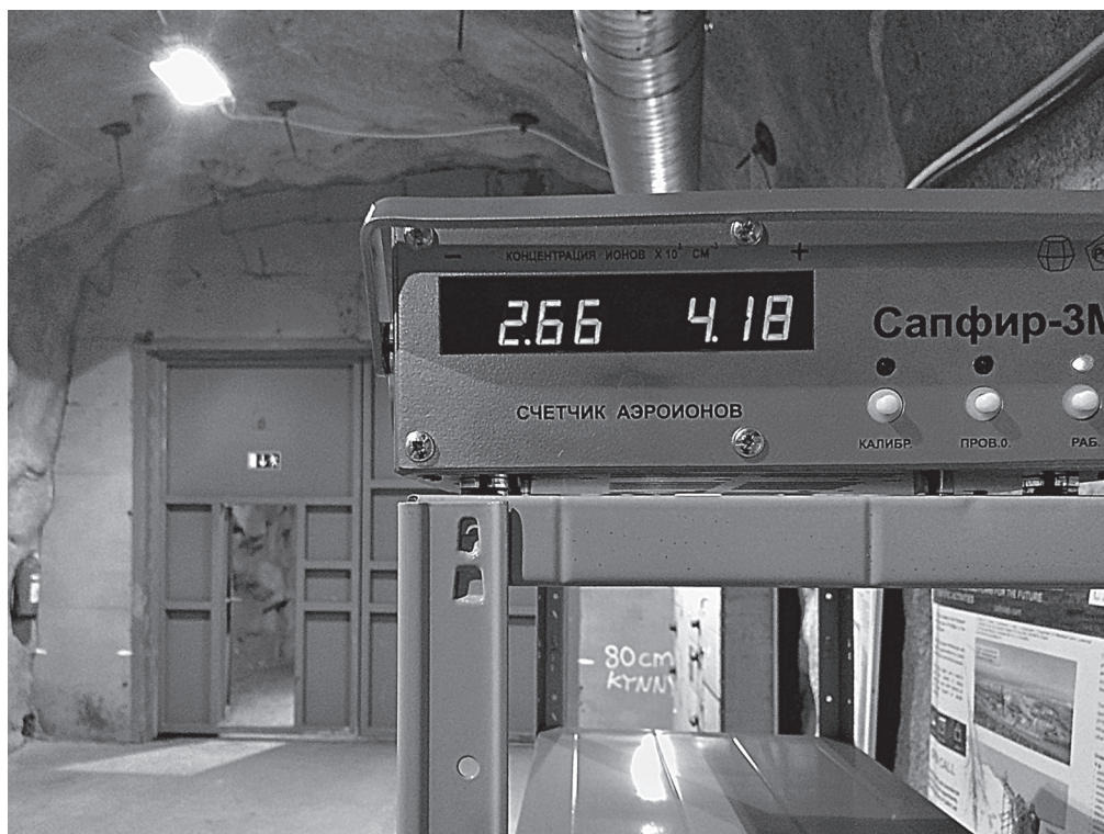
Рис. 3. Фото серийного счетчика ионов Сапфир-3М, расположенного в подземной лаборатории Центра подземной физики частиц (CUPP) университета Оулу (Финляндия) в медной шахте Пюхясалми (Puhäsalmi) на глубине 1440 м. На дисплее счетчика видны значения измеренных концентраций: отрицательно заряженных аэроионов – 2.66 \times 10^3 \text{ см}^{-3} и положительно заряженных аэроионов – 4.18 \times 10^3 \text{ см}^{-3} .
