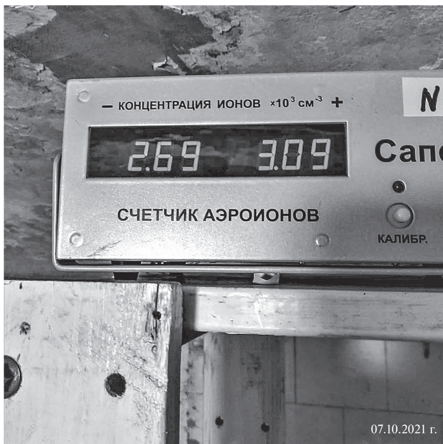
Рис. 2. Фото модифицированного счетчика ионов Сапфир-3М, расположение которого показано на рис. 1. На дисплее счетчика видны значения измеренных концентраций: отрицательно заряженных аэроионов — 2.69 \times 10^3 \text{ см}^{-3} и положительно заряженных аэроионов — 3.09 \times 10^3 \text{ см}^{-3} .
