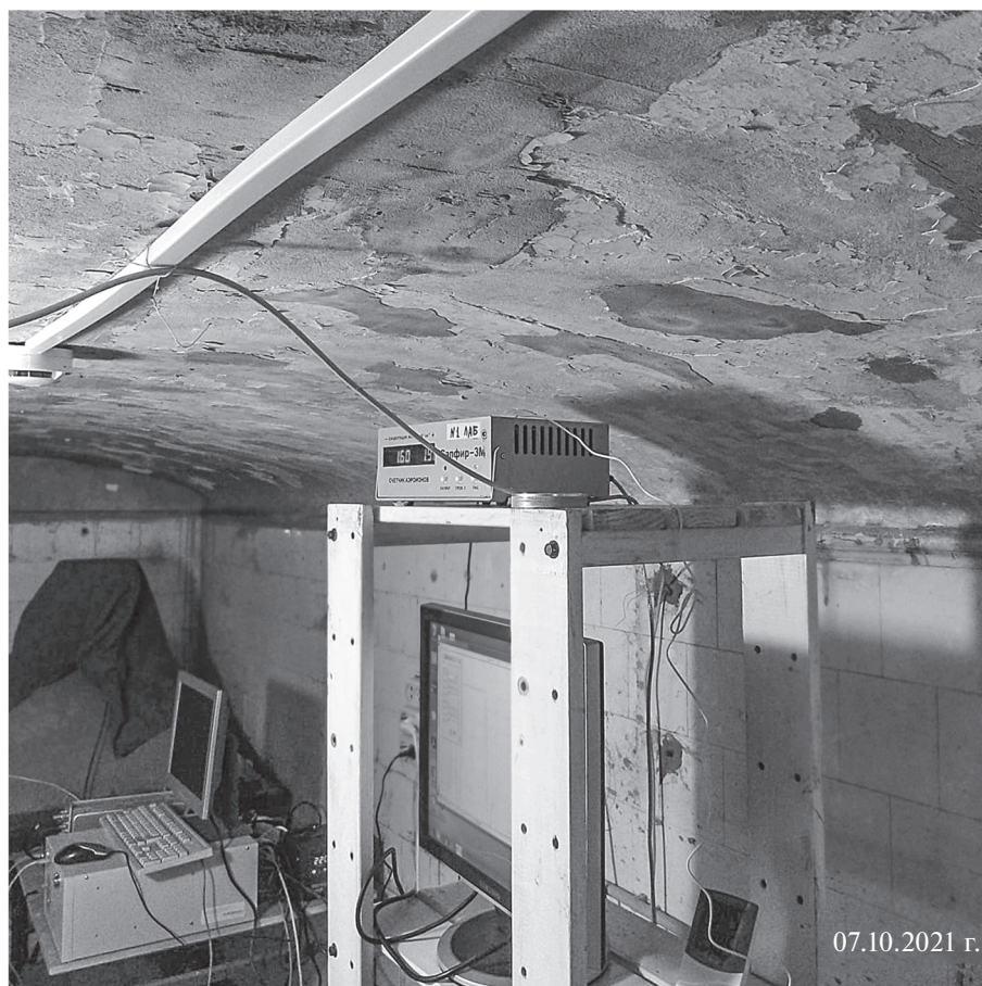
Рис. 1. Фото автономного стенда по долговременному наблюдению за избытком положительно заряженных аэроионов, расположенного в подземной неветилируемой лаборатории НИИЯФ МГУ глубиной 12.7 м. Под потолком расположен модифицированный счетчик ионов Сапфир-3М.
