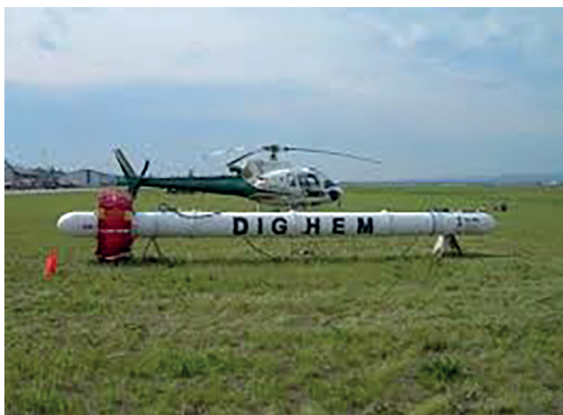
Рис. 7. Частотная система с жестким креплением передатчика относительно приемника DIGHEM.
