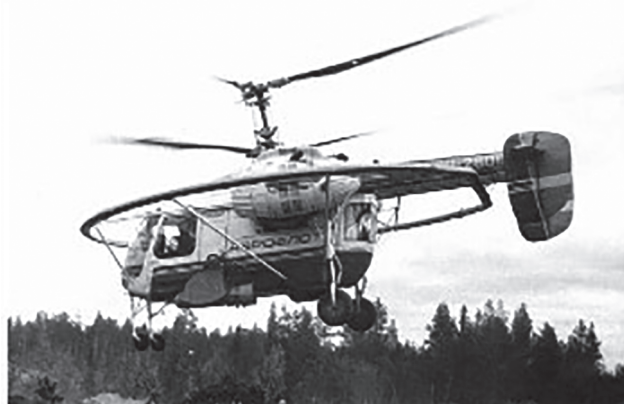
Рис. 5. Активная система, реализующая аэрометод переходных процессов АМПП-2, 1970-е.
