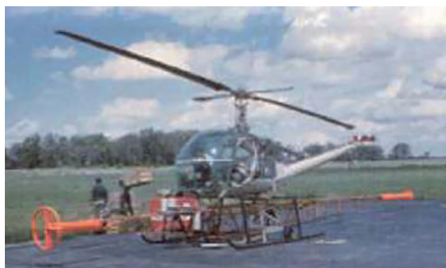
Рис. 4. Частотная система с жестким креплением передатчика относительно приемника Texas Gulf Sulphur, 1964 г.
