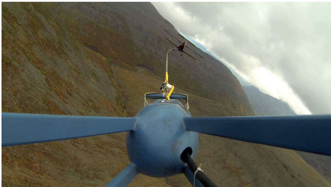
Рис. 8. Частотная система с нежестким креплением передатчика относительно приемника ЕМ-4Н во время съемки, 2014 г.
