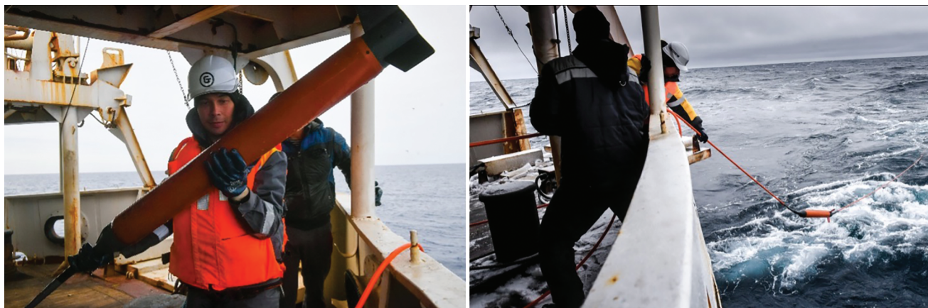
Рис. 10. Работы с протонным морским магнитометром в море Дюрвиля по определению ЮМП.
