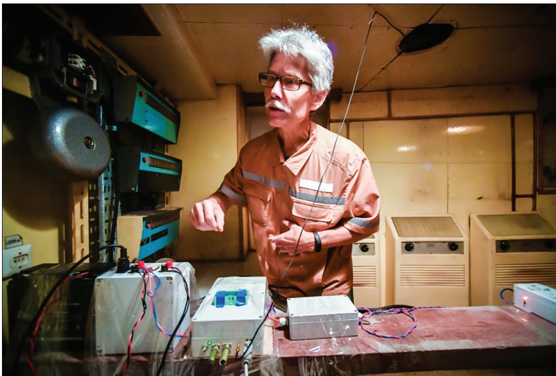
Рис. 7. Магнитовариационный комплекс MVC-2 разработки ИЗМИРАН в магнитометрической лаборатории на ОИС “Адмирал Владимирский”.
