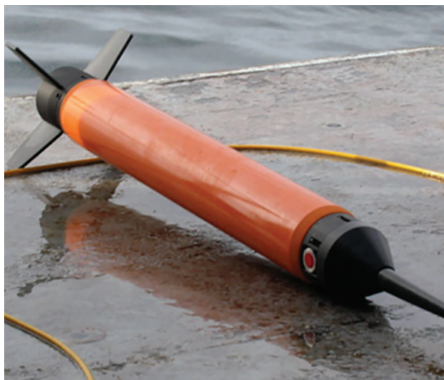
Рис. 6. Гондола морского буксируемого протонного магнитометра SeaSPY.
