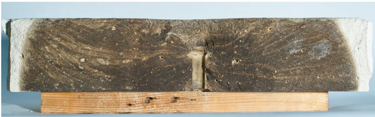
Рис. 17. Образец после проведения эксперимента 2, разделенный по трещине ГРП. Ориентация образца сохранена.
