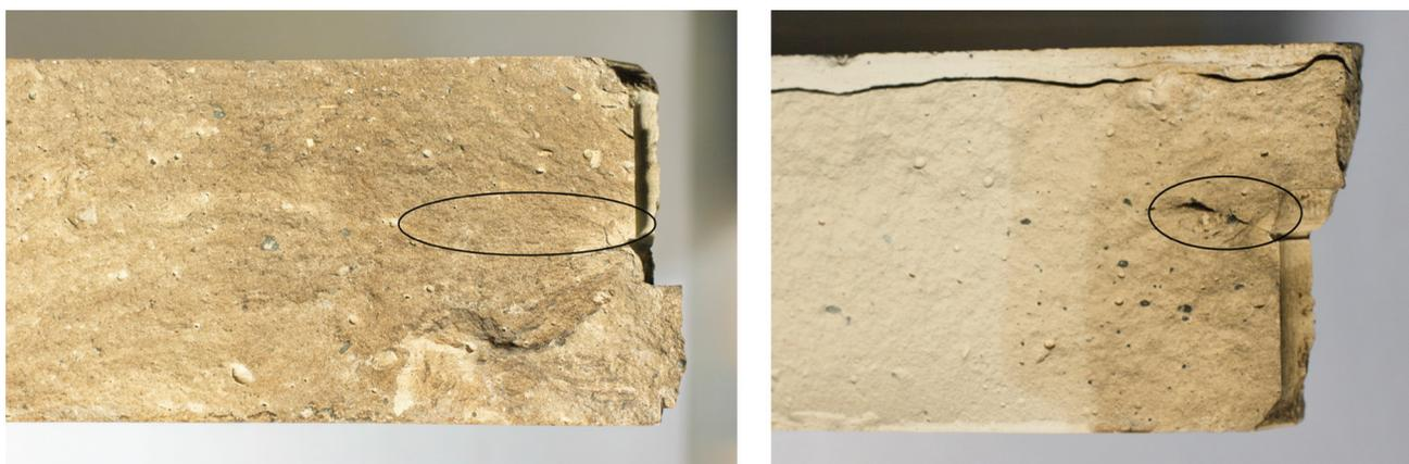
Рис. 18. Разлом образца в плоскости  $X$ , образованный вертикальной трещиной ГРП (слева), и в плоскости  $Y$ , образованный раскалыванием (справа). Эллипсами указана область, в которой расположена субгоризонтальная трещина первичного ГРП.
