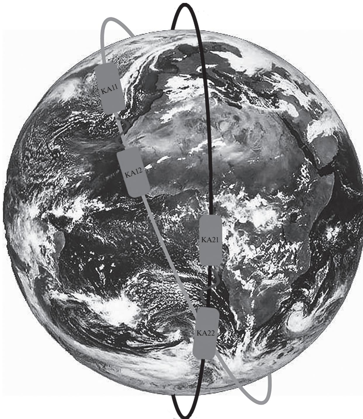
**Рис. 5.** Положение в пространстве группировки МГ2, состоящей из двух орбитальных плоскостей с параметрами:  $h_{1,2} = 400$  км;  $i_1 = 89.5^\circ$ ,  $i_2 = 70^\circ$ ;  $\Omega_1 = 0^\circ$ ,  $\Omega_2 = 160^\circ$ .
