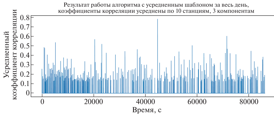
Рис. 6. Результат детектирования с усредненным шаблоном по всем станциям и компонентам CC_{\text{среднее}} < CC_{\text{пороговое}} (в данном случае пороговое значение коэффициента корреляции 0.12).
