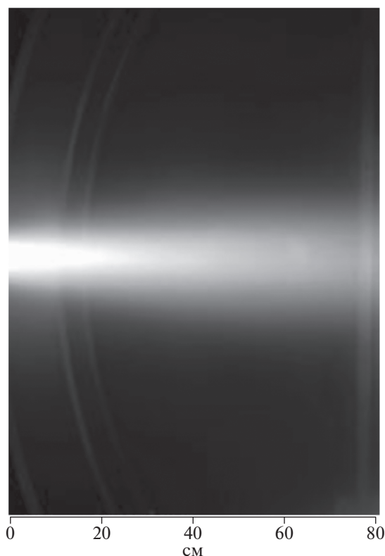
Рис. 3. Фотография плазмы, вылетевшей из кварца под влиянием ударной волны.
