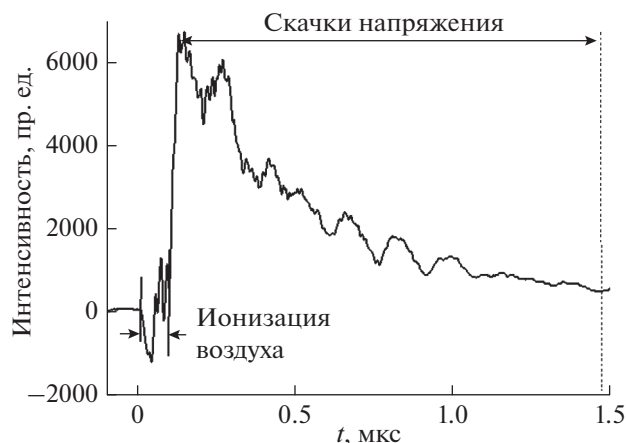
Рис. 7. Скачки напряжения в измерительном приборе, вызванные горением электрической дуги.
