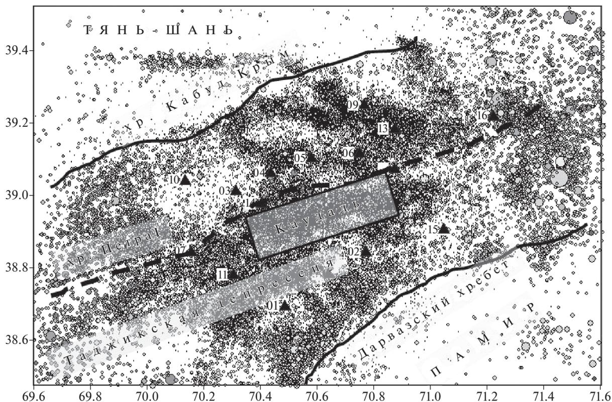
**Рис. 1.** Элементы тектоники и система сейсмологических наблюдений на Гармском полигоне КСЭ ИФЗ АН СССР. Треугольники с номерами – сейсмические станции. Мелкие кружки – эпицентры землетрясений с  $M \geq 0.5$ , произошедших в период с 01.01.1955 по 31.03.1992 гг. Прямоугольный квадрат в центре – локальный район (ЛР) Каудаль, используемый для исследования временных вариаций  $b$ -value с глубиной.
