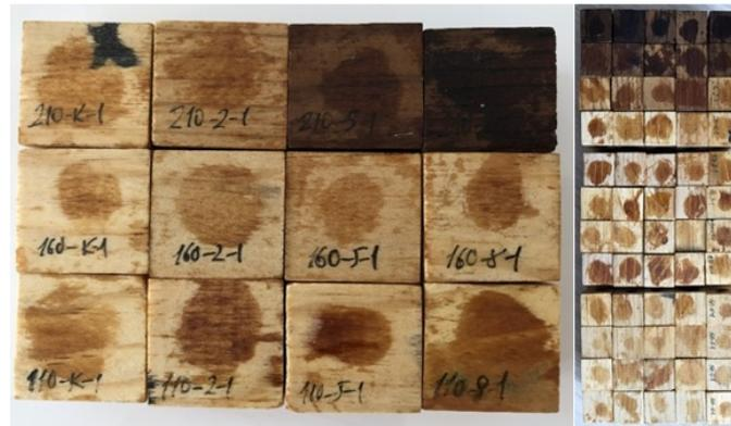
Рис. 1. Изменение цвета образцов, подвергнутых трем различным температурам и временам выдержки.
