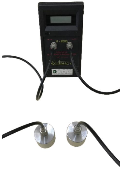
Рис.1. Традиционное оборудование для испытания ультразвуковыми волнами.
